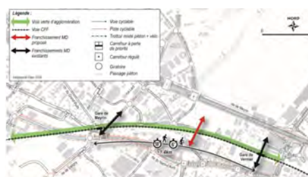
Schéma illustratif : Les franchissements actuels et proposés : passage dénivelé chemin des Batailles.
