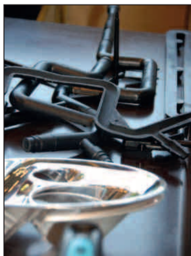
■ Fabrication de prototypes de pièces destinées à l'industrie automobile pour remplacer les parties métalliques plus lourdes.
